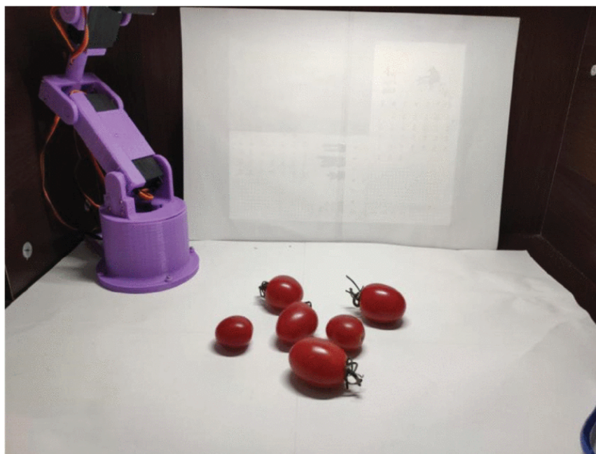
Сурет 1.24 – Қызанақтарды сұрыптайтын манипуляторлық жүйе [76]
