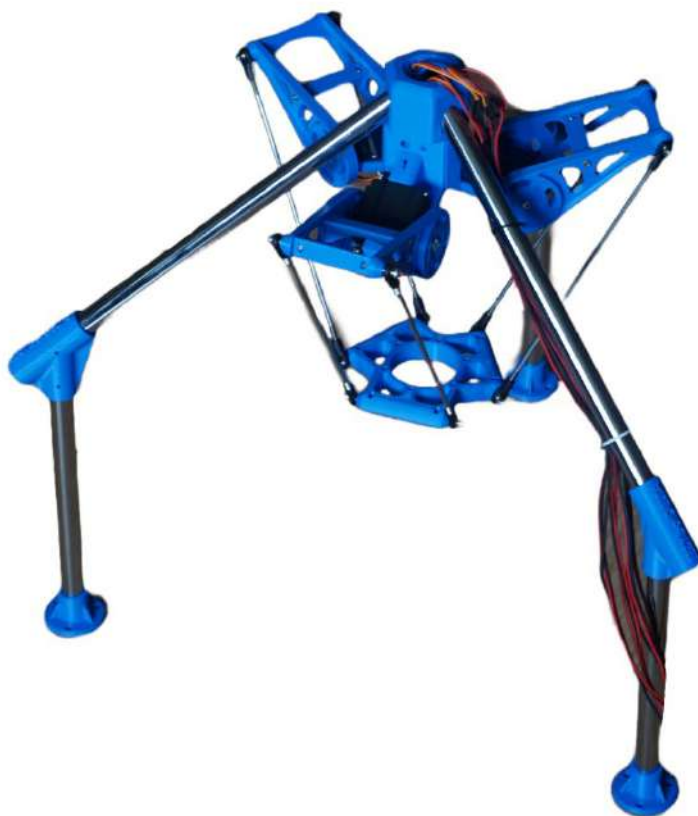
Сурет 3.2 – Жиналған дельта манипулятор [75]
